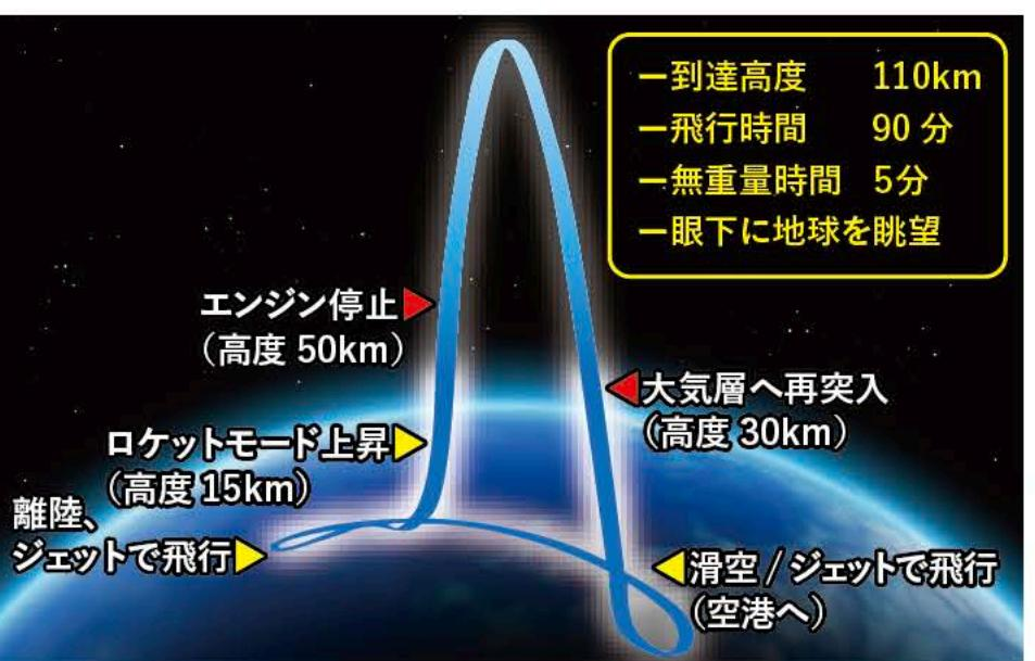
たとえば、帰還時にジェット燃焼モードに切り替えられることで、着陸のやり直しや別空港への振り替えが可能となり、飛行の安全性が高まります。また、ジェット燃焼モードなら上空待機や短い滑走路での離着陸もできるため、既存空港の滑走路を使用でき、大幅なコスト低減に繋がります。
